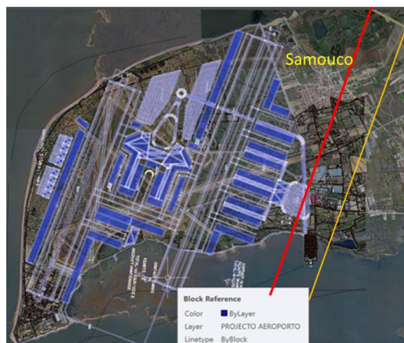
Figura 2 – Aeroporto no Montijo com duas pistas. Envolventes das isófonas dos níveis de ruído superiores a 65 dBA (a vermelho) e a 55 dBA (a amarelo).
